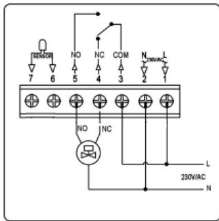
Схема подключения к котлу:
